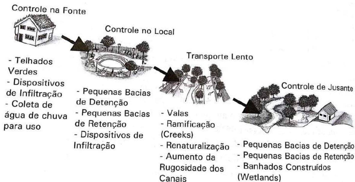
Figura 31: Categorização das técnicas compensatórias, segundo sua localização no sistema de drenagem
