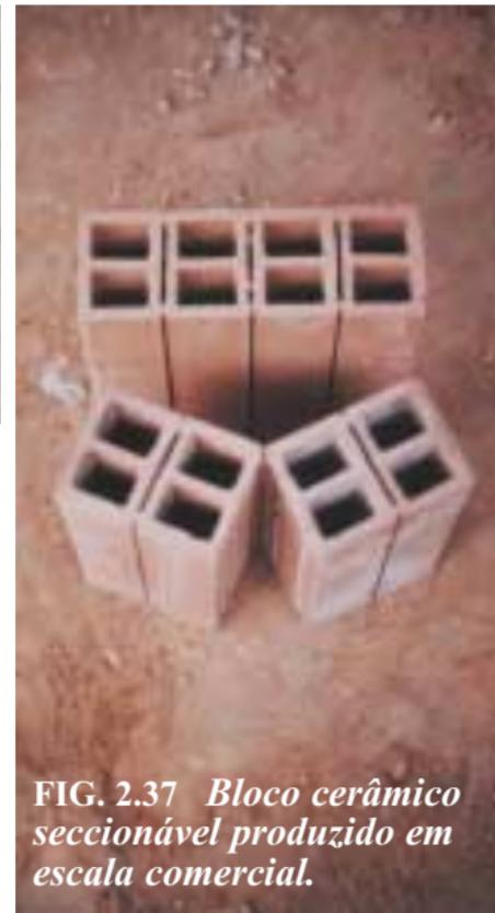
**FIG. 2.37** *Bloco cerâmico seccionável produzido em escala comercial.*
