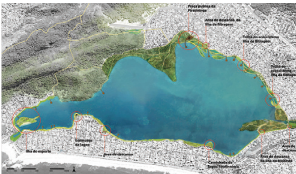
Figura 53. Plano dos parques com várzeas para filtrar os escoamentos antes de chegarem à lagoa e localização de vários usos e equipamentos.
