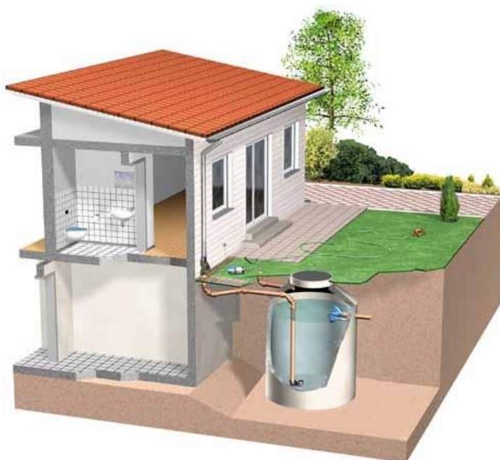
Figura 26: Esquema conceitual de reservatório individual
