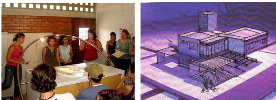
FIGURA 08 – Estudo da insolação no heliodon e croquis do aluno Eduardo Albuquerque. Fonte: acervo da disciplina
